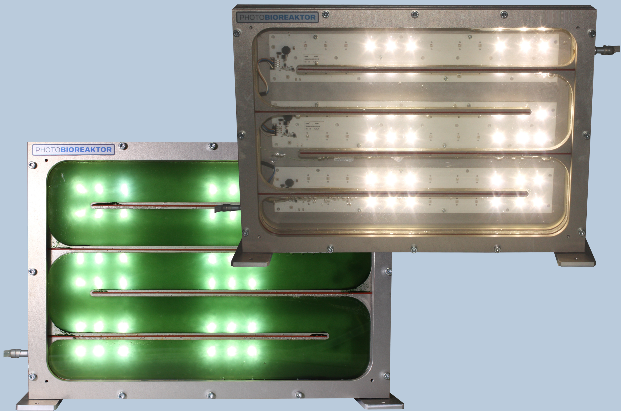
Bild 3 und 4: Photobioreaktoren mit einem LED-Modul (3 Platinen mit weißem Licht), Frontscheibe aus Glas, mit Algensuspension bzw. mit Wasser gefüllt
