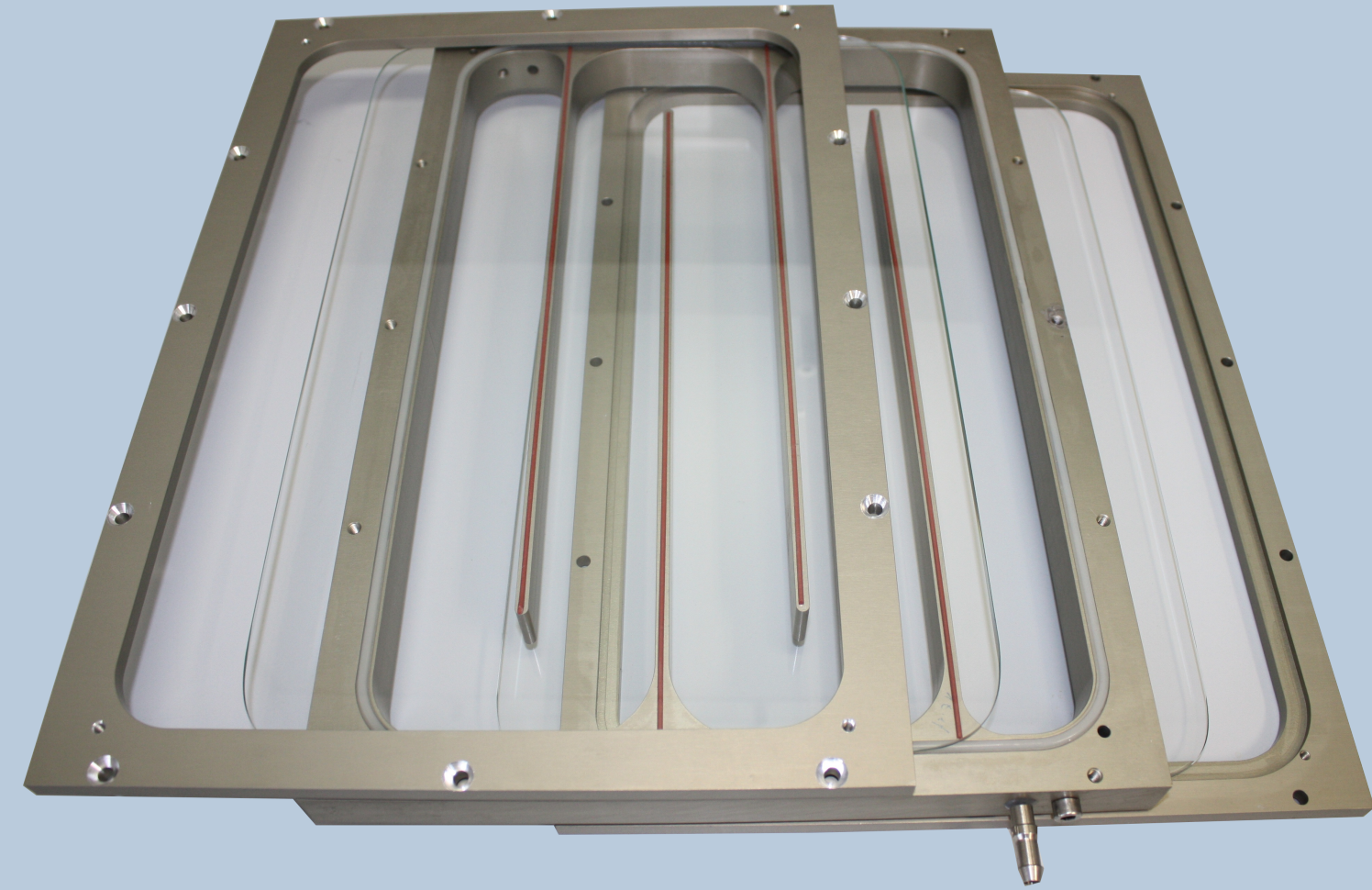
Bild 2: Einzelteile des Photobioreaktors in folgender Reihenfolge: Rahmen, Frontscheibe, Photobioreaktorgrundkörper, Frontscheibe, Rahmen
