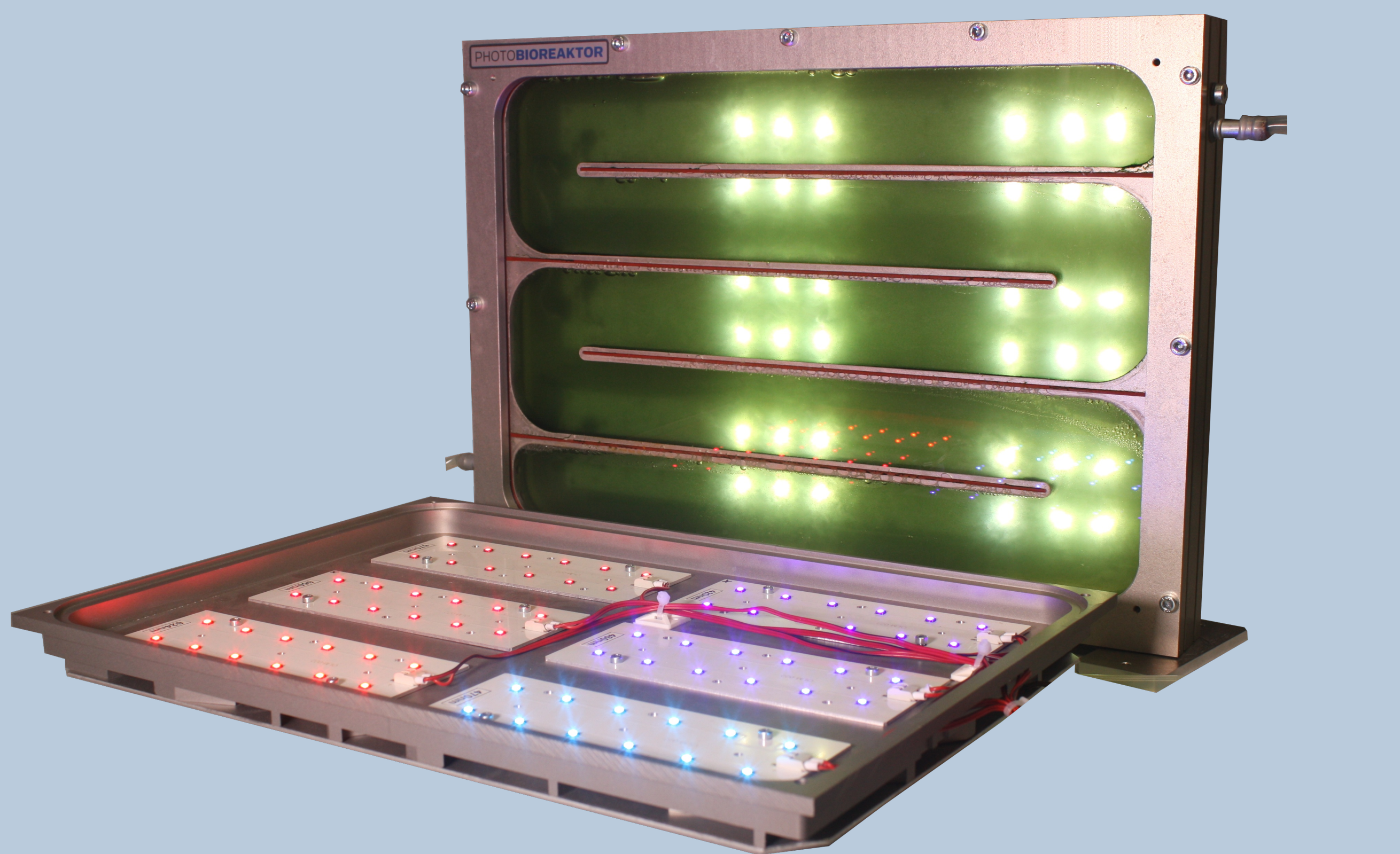
Bild 5: Vordergrund: LED-Modul (bestückt mit 6 Platinen mit roten und blauen LEDs) kann zusätzlich an den Photobioreaktor befestigt werden Hintergrund: Photobioreaktor mit Algensuspension und LED-Modul (3 Platinen mit weißem Licht)
